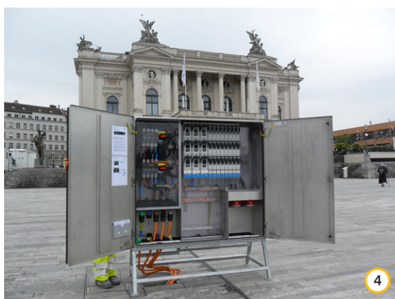
Robusto armadio di distribuzione in versione inossidabile GIFAS 800 A. Alimentazioni innestabili 2x400A su PowerSAFE Panelbox. Uscite dirette mediante NH e CEE 125 + 63A innestabili
